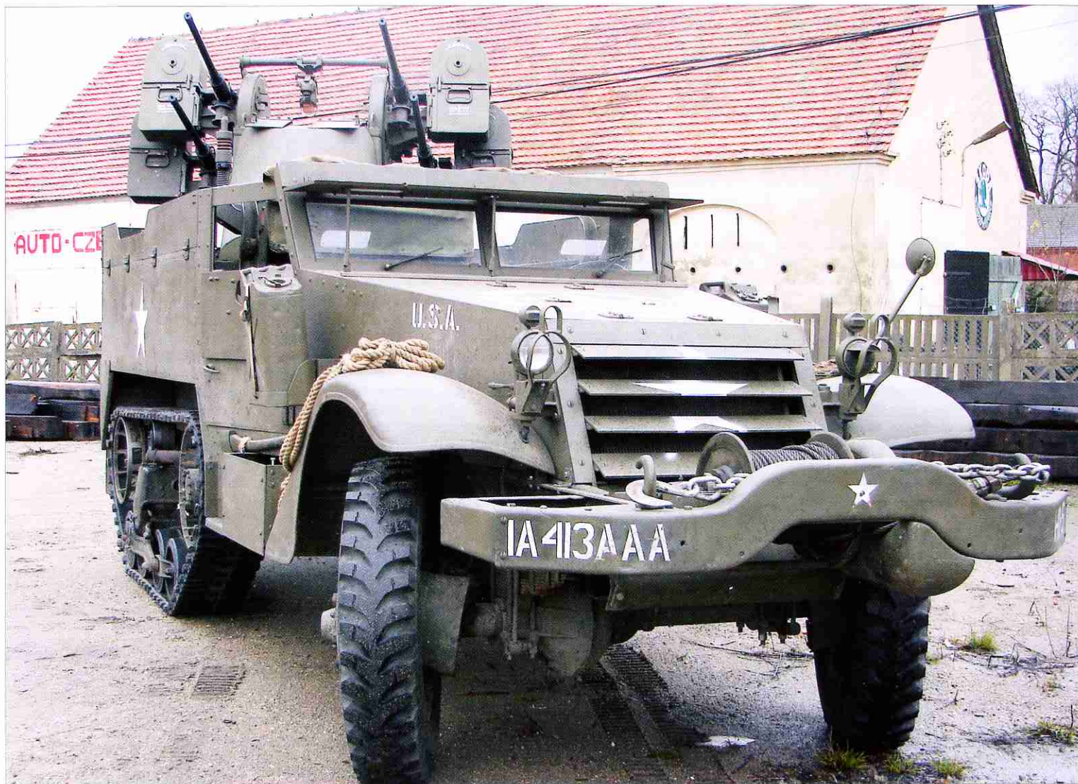
The M16 carrier's armour was made of 12.7 mm rolled steel in the front, and 6.3 mm on the sides and in the rear • Pancerz transportera M16 wykonany był z płyt walcowanych o grubości: przód 12,7 mm, boki i tył - 6,3 mm
